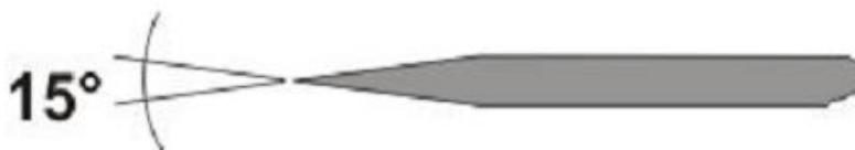
Рис 1. Форма заточки вольфрамового электрода
