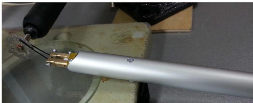
Рис. 3 Заточка внутренней поверхности электродов (Вариант №2)
