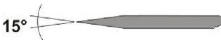
Рис. Форма заточки вольфрамового электрода
